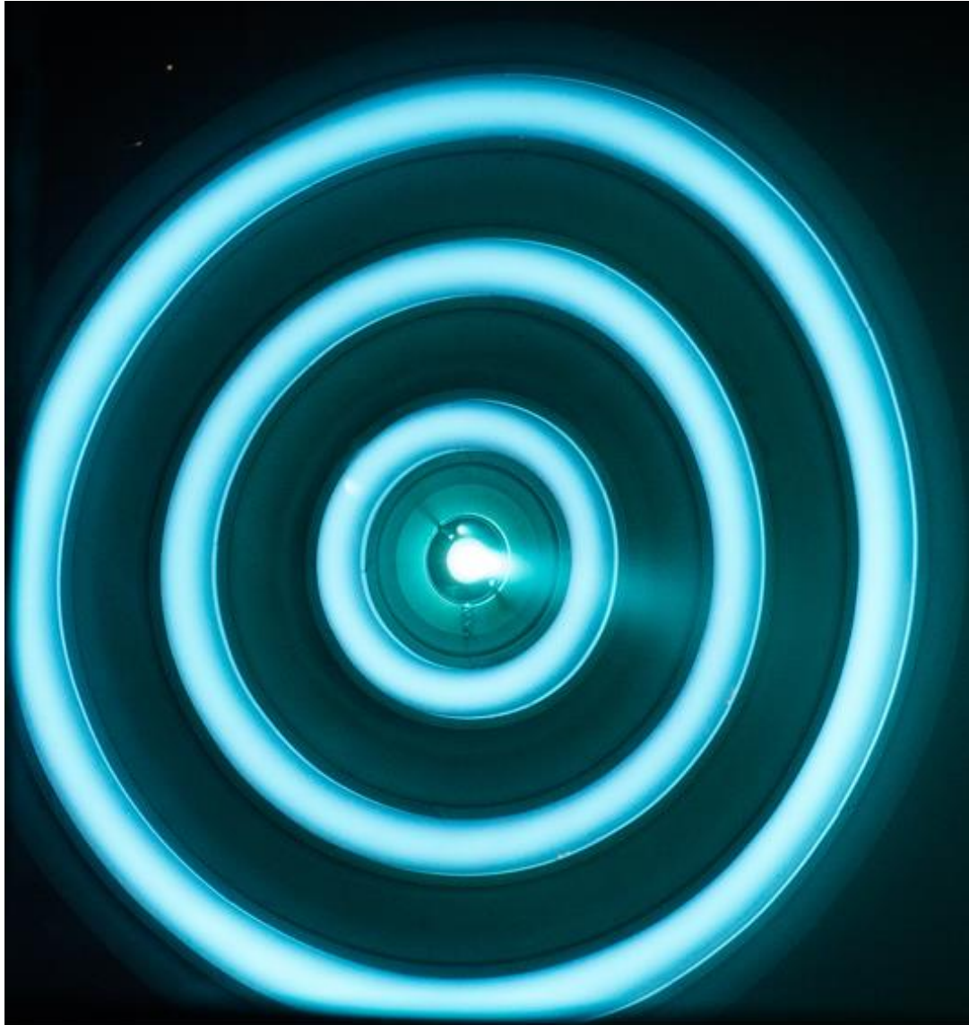
UM X3 thruster – 100 kW class
