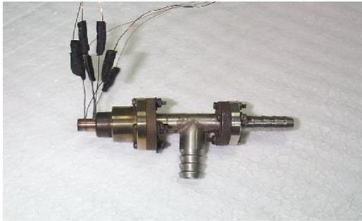
Fig. 2 The picture of arcjet
